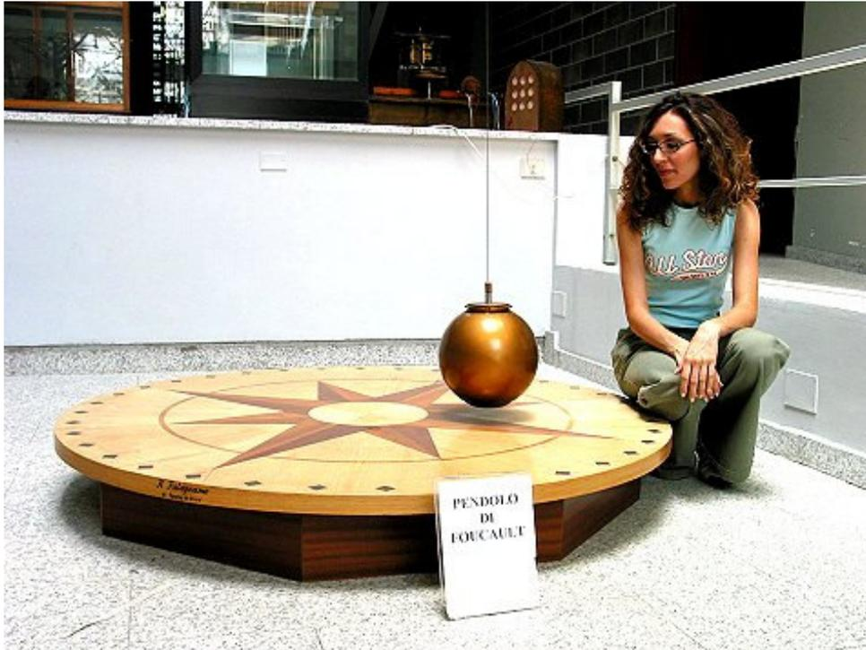
Questo è il pendolo sito nell'atrio centrale del Dipartimento di Fisica. Sotto al piano intarsiato con la rosa dei venti è posizionato l'elettromagnete che mantiene il pendolo costantemente in oscillazione. Il piano di oscillazione ad ogni ora ruota all'incirca di una delle tacche visibili alla periferia del piano di riferimento.
